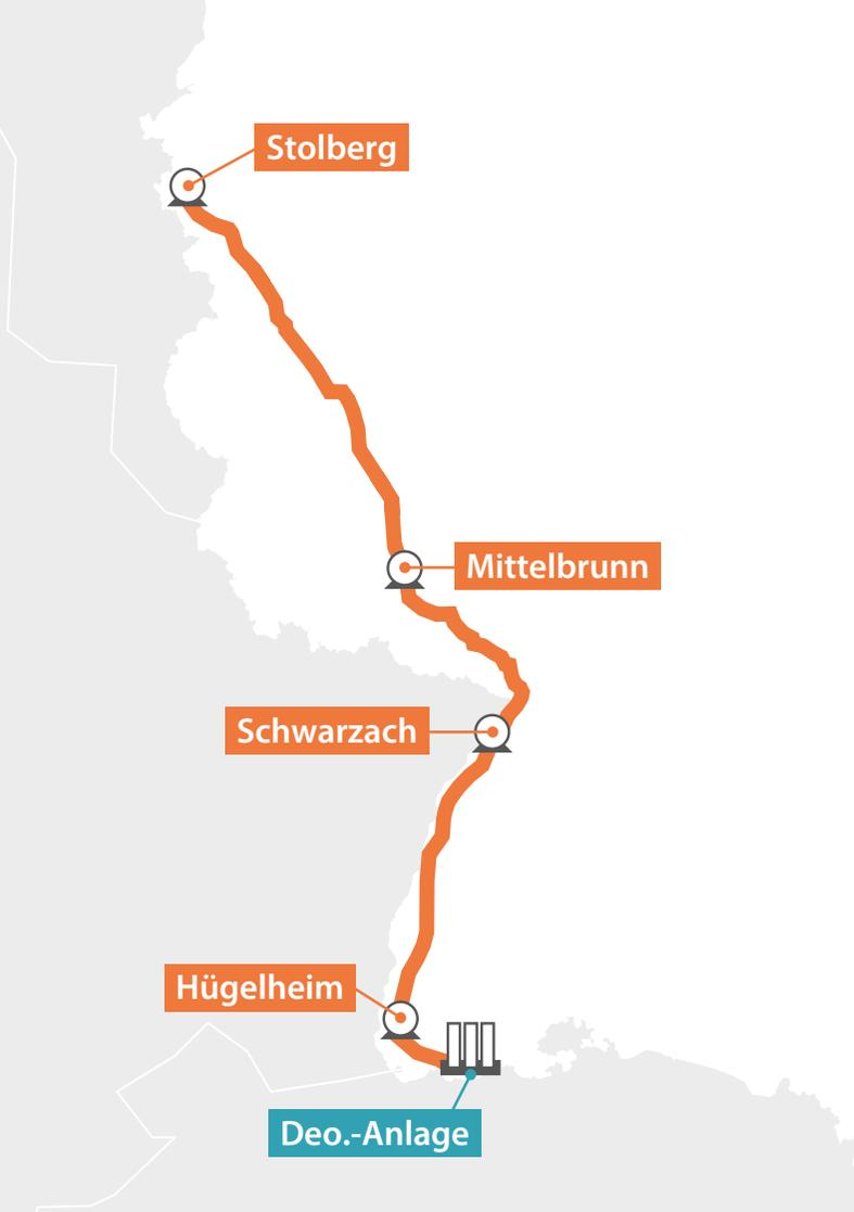
In der Deodorierungsanlage in Schwörstadt werden Geruchsstoffe aus dem Erdgasstrom beim Süd-Nord-Transport im Fernleitungssystem der TENP nach dem Prinzip der Adsorption an einem Granulat entfernt.
